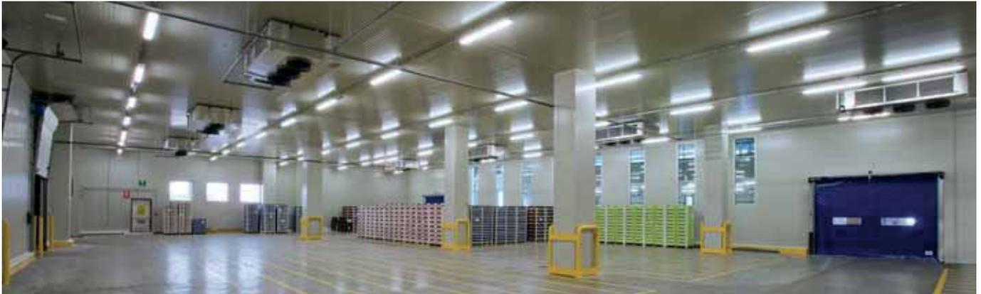
Pannelli metallici a doppio rivestimento metallico, coibentato in poliuretano espanso. Le elevate prestazioni di isolamento termico e la qualità del sistema di giunzione, li rendono particolarmente idonei per la realizzazione di ambienti nei quali sia richiesta una temperatura controllata, come celle frigo e camere di lavorazione.
